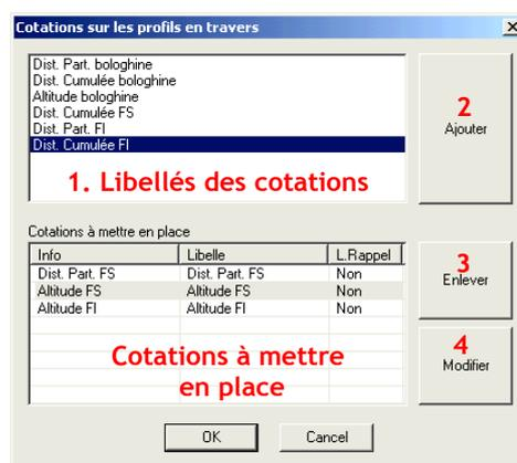
Bdiag. 40 Cotation à mettre en place dans la matrice des profils en travers
