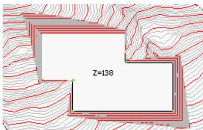
Fig. 75 Modèle de terrain initial fusionné avec le modèle de terrain de la plate forme
